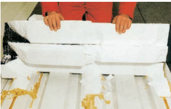
Überzeugendes Klebeergebnis des ausgehärteten PUK Dämmstoffklebers . Beim Versuch, die Klappbahn wieder zu entfernen, wird diese zerstört.
