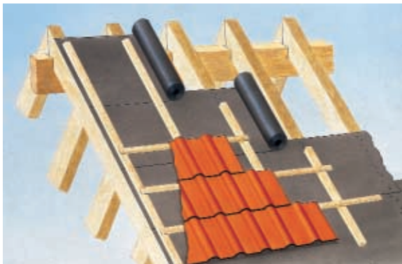
ELMO-Protect Z - Verlegung direkt auf die Sparren
