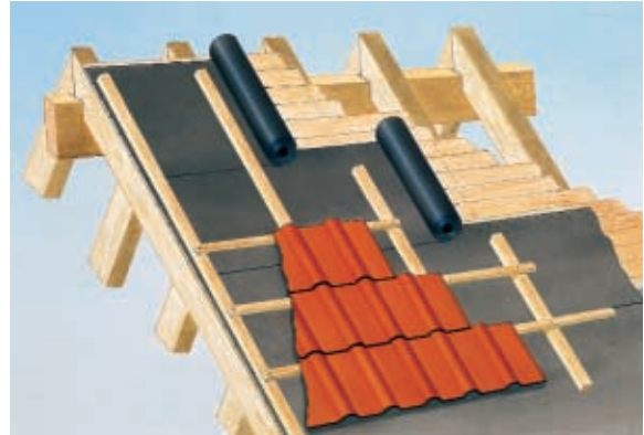
ELMO-Protect V - Verlegung auf Holzschalung
